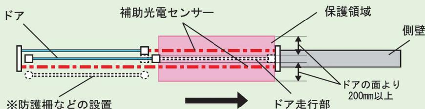
※JADAの推奨事項としてFix(袖壁)側たて枠に補助光電センサーを設置する場合は、衝突防止のため防護柵などを設置することが望ましい。
