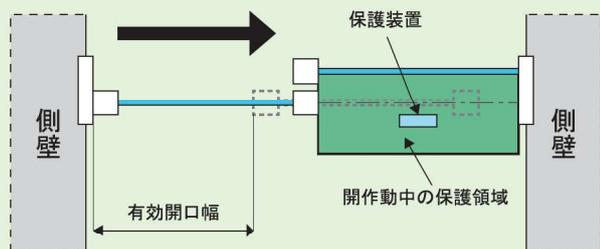
e 戸尻の領域が、ドアの前に8mm以下、又は25mm以上100mm以下の距離に位置するガードスクリーンでカバーされていること。
