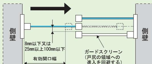
f 戸尻の領域が、ドアの前に8mm以下、又は25mm以上100mm以下の距離に位置する防護柵でカバーされていること。
