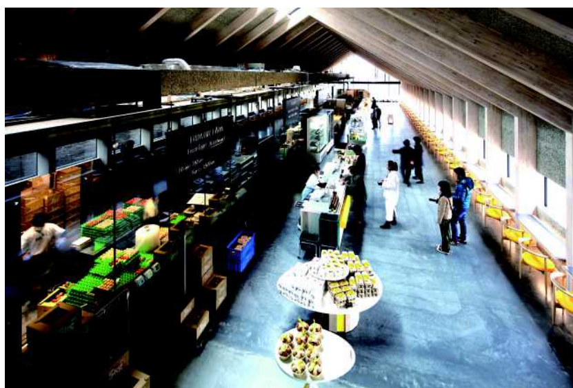
GTR工法により13mスパンの無柱空間としたゆとりのある店舗
